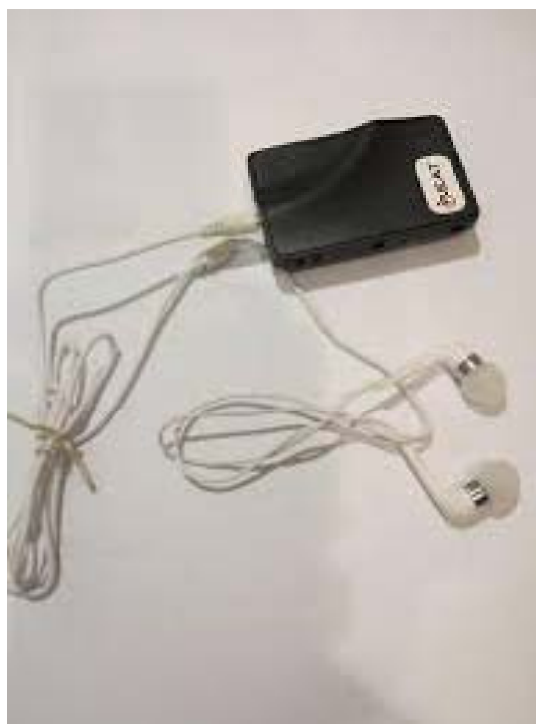
เครื่องช่วยฟังดิจิทัลแบบพกพา เชื่อมต่อกับโทรศัพท์มือถือผ่าน ทางบลูทูธ ใช้แบตเตอรี่แบบรีชาร์จ
